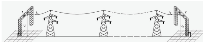
Slika 2. Zaštitno uže nadzemnog voda [3]
