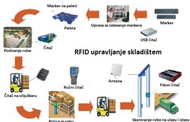
Slika 2. Skica upravljanja skladištem opremljenim IoT konceptom
