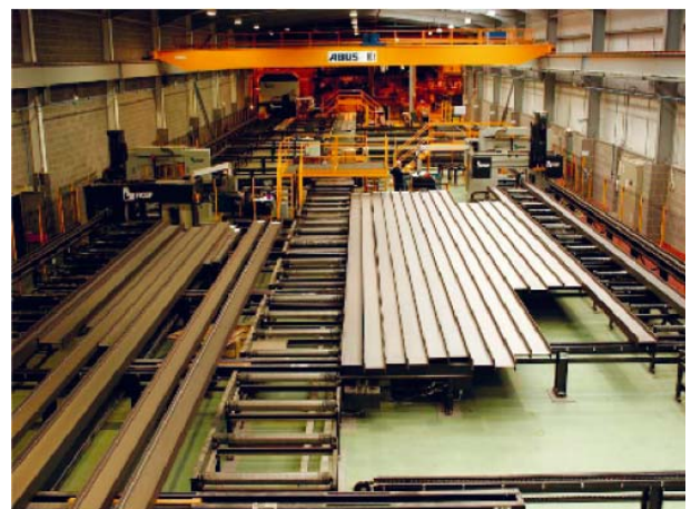
Slika 4. Proizvodnja konstruktivnih elemenata na CNC mašinama
