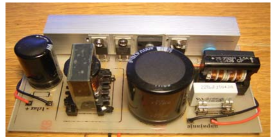
Slika 2. Eksperimentalni prototip integrisanog "buck-flyback" pretvarača.
