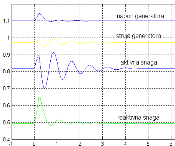
Slika 5.2 Odziv karakterističnih veličina na step smetnju u trajanju od 200ms, koja se dobijaju upotrebom GUI modela jednog generatora iz HE „Perućica“
