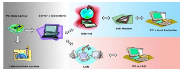
Slika 1. Povezivanja računara na laboratorijski server
